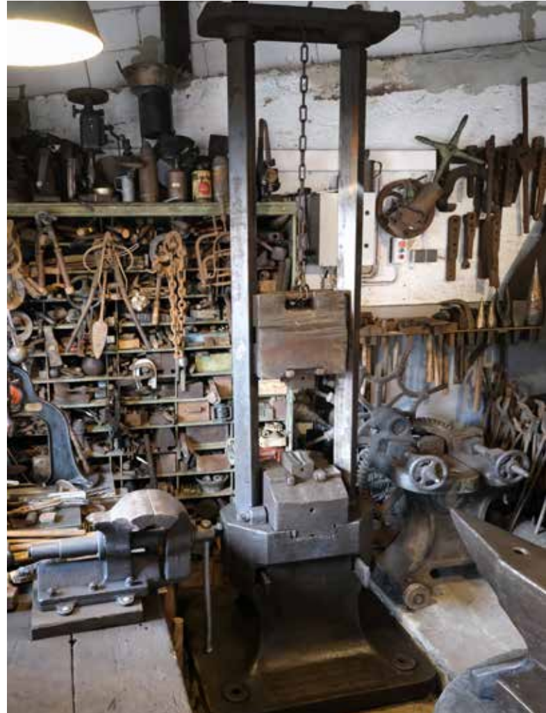
Der Riemenfallhammer hat eine vorgefertigte Form mit Ober- und Unterteil, in die das heiße Eisen gelegt und dann gepresst wird.
